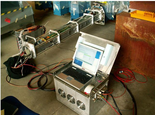
▲ **Figure 5** : Banc test portable MobiDICK des super-tiroirs.
