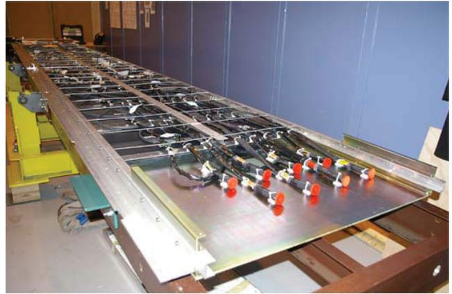
▲ **Figure 10** : Photo d'un super module après installation des torons de fibres optiques et d'une partie des boîtes.
