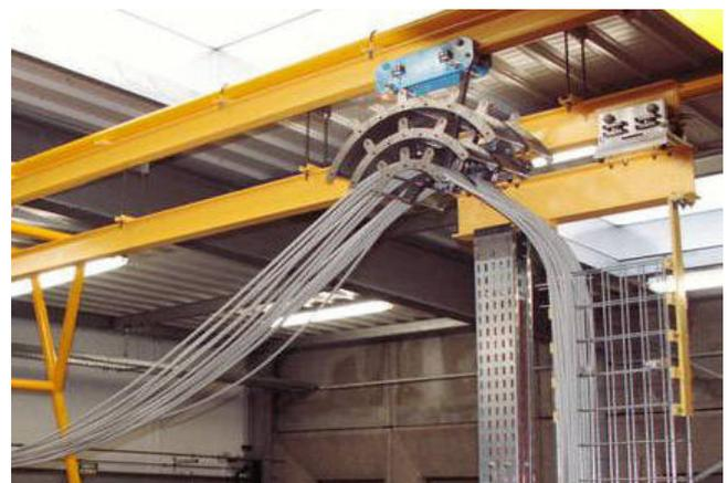
▲ **Figure 19** : Maquette échelle 1 des chariots porte-câble et de la colonne de service.
