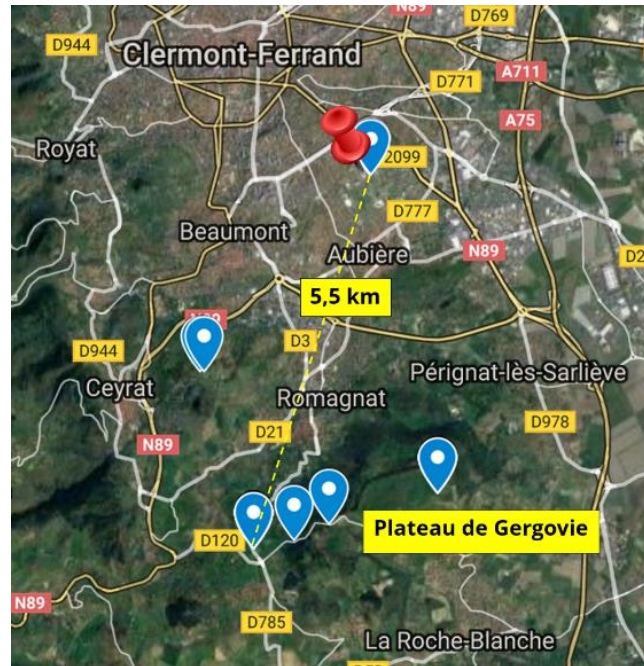
Test de portée (passerelle sur Campus des Cézeaux)
