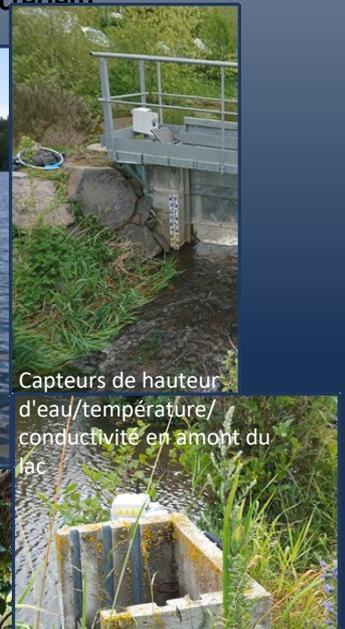
Capteurs de hauteur d'eau/température/conductivité en amont du lac
